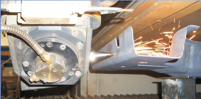
Die Bearbeitung von Tiefziehteilen ist ein besonderes Einsatzgebiet unserer 3D-Laserstrahlanlage. In diesem Fall werden Zugproben aus einem Bauteil geschnitten.
